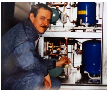
1988 kom kylmaskinen KEA och 1992 kom KEAQ som kombinerar kylvärmepump med roterande värmväxlare.
